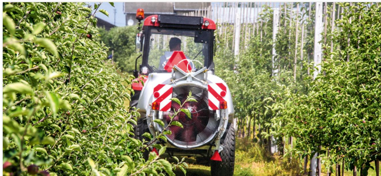
Основные требования к опрыскивателям для садов супер- и интенсивного типов определяются узкими междурядьями и небольшой высотой деревьев. В первую очередь применение в данной области находят навесные и прицепные вентиляторные агрегаты. Однако наряду с развитием вентиляторно-турбинного сегмента появляется альтернативная техника, способная в перспективе занять достойные места в ангарх российских садоводов.
