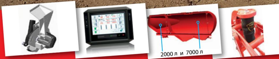
Пневматическая подушка, обеспечивающая давление высевальной секции до 250 кг.
