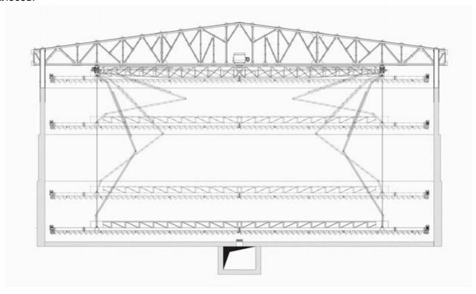
Здание зернохранилища разделено на отсеки ж/б стенами, что позволяет хранить различные по виду и качеству культуры. Металлический каркас представляет собой поперечные рамы, развязанные в продольном направлении связями по фермам и прогонам.
